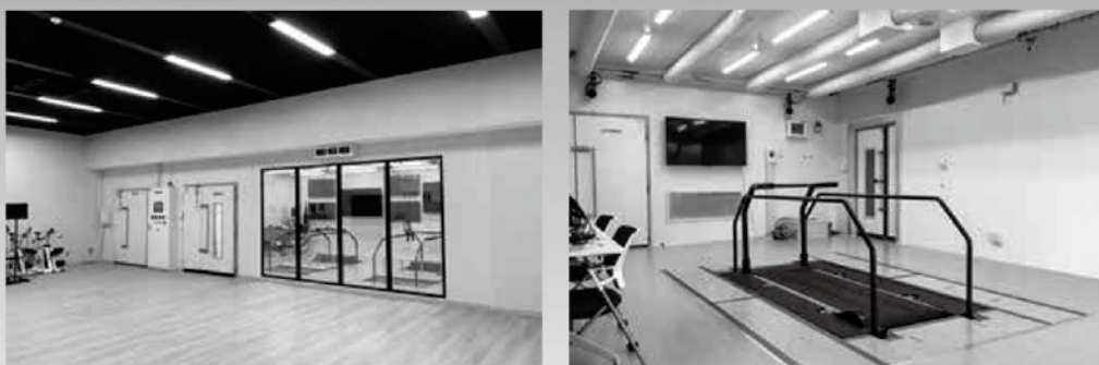
特注・ハイグレード型 運動生理学用試験研究装置 温度:5~45℃ 湿度:30~80% 酸素濃度:18~13%
