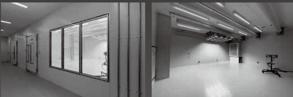
特注・ハイグレード型 運動生理学用試験研究装置 温度:-30~40℃ 湿度:30~80% 2室仕様(1室はHC機能を含む)
